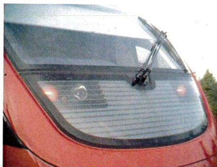
**Abbildung 14: Talent mit Blinker/BOStrab-Zulassung<sup>42</sup>**
